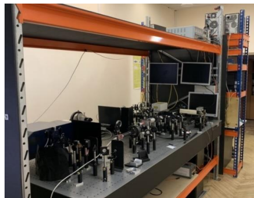
Рис. 2. Фотография установки лазерного нагрева веществ в ячейках высокого давления
